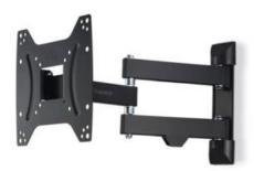
support mural, correspond pour écran plat, 48 cm, 19 pouces, 122 cm, 48 pouces, charge admissible jusqu'à 20 Kg, norme VESA, intervalles entre les trous 75 x 75 mm, 100 x 100 mm, 200 x 100 mm, 200 x 200 mm, extensible, inclinable, Inclinaison -12 degrés/+5 degrés, pivotant, 3 articulations, secteur pivotant 18 degrés
